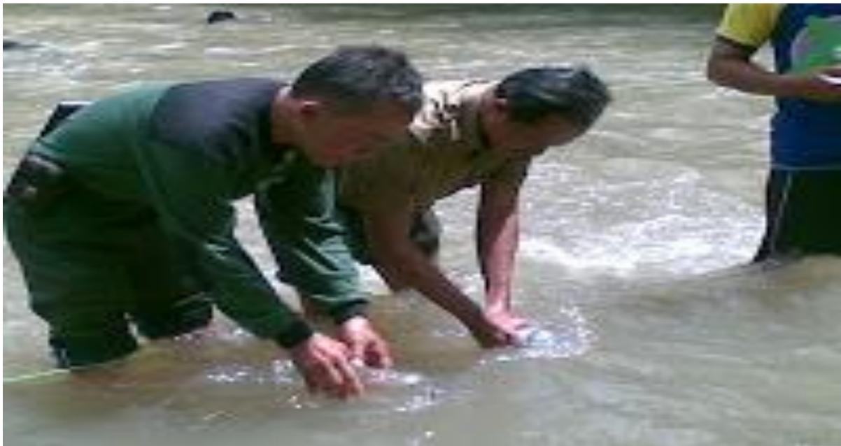
**Gambar 2.18:** Pengambilan Sampel dengan Sistem *Wading*
